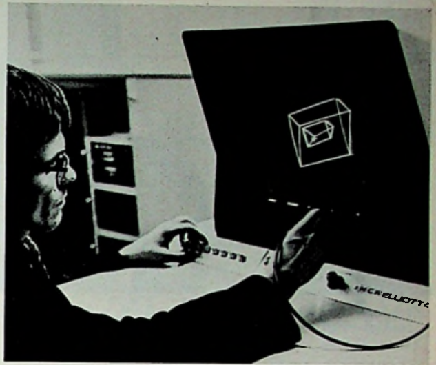
Dit beeldstation met lichtpen werd ontwikkeld door GEC-Elliott Automation Ltd. De installatie bestaat uit een beeldkast met toetsenbord, lichtpensysteem, bedieningselektronica en een kleine computer.
